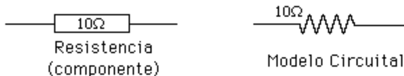
Fig. 12.- Resistencia real y modelo circuital
